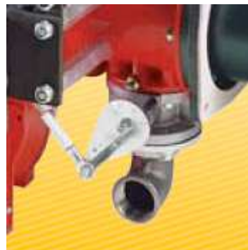
Příklad vačky proměnného profilu na modelech GAS P/M
