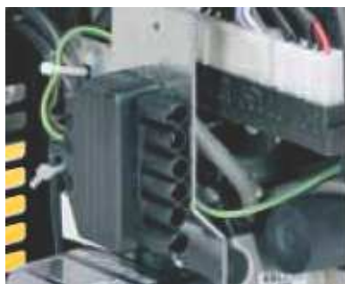
FS3 je opatřen svorkovnicí, FS5, FS10 a FS20 vybaveny 7- a 6-pólovými zásuvkami; FS8 k dostání v obou konfiguracích.
