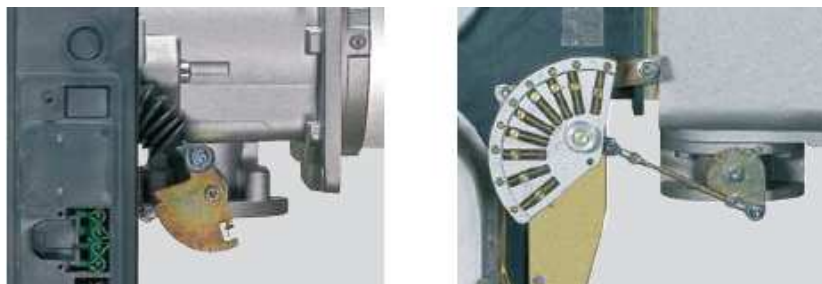
Příklad vačky s proměnným profilem u hořáku RS 34-44/M MZ a RS 250/M MZ
