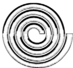
Spirálová konstrukce dovoluje eliminovat expanzi spalinových plynů
